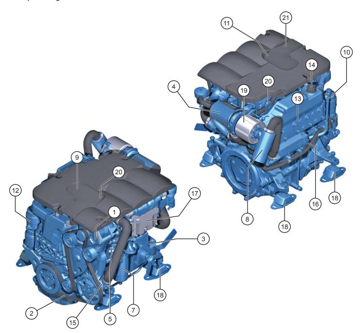
Certains équipements peuvent ne pas faire partie de votre moteur. Les moteurs équipés d'un système de refroidissement par Keel Cooling ne sont pas équipés d'une pompe à eau de mer.
