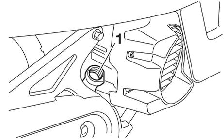
1. Orifice de remplissage d'huile moteur
