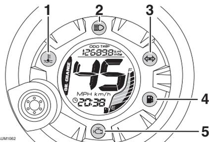
1. Témoin d’alerte de la température du liquide de refroidissement “”
