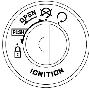
Le contacteur à clé/antivol commande les circuits d'allumage et d'éclairage et permet de bloquer la direction. Ses diverses positions sont décrites ci-après.
