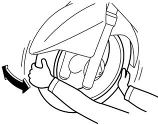
Contrôler les roulements de roue avant et arrière aux fréquences spécifiées dans le tableau des entretiens et graissages périodiques. Si le moyeu de roue a du jeu ou si la roue ne tourne pas régulièrement, faire contrôler les roulements de roue par un concessionnaire Yamaha.
