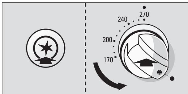
3. Le gaz qui s'échappe du brûleur inférieur au gaz du four s'enflamme par l'intermédiaire du bouton allume-gaz. Continuer d'appuyer à peu près pendant 10 secondes sur le bouton du brûleur inférieur au gaz du four, pour que le système de sécurité flamme se mette en marche.
