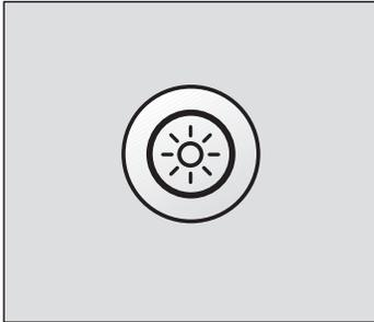
1. Appuyer sur le bouton multifonction. Lorsque l'on appuie sur le bouton, le gril électrique et la broche tournante se mettent en marche en même temps. La lampe du four s'allume.
