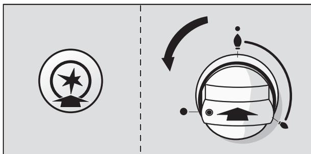
4. **Maintenir** le bouton de bec **appuyé** à peu près durant 1 à 3 secondes. C'est ainsi que le système de sécurité flamme se met en marche. Le système de sécurité flamme coupe automatiquement la sortie du gaz en cas d'extinction de la flamme.
