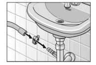
☐ A l'aide d'un collier (diamètre entre 24 et 40 mm), bloquez la jonction entre le flexible et l'embout du siphon.
