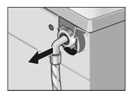
☐ Dévissez le raccord unissant le flexible d'arrivée d'eau et l'orifice d'entrée dans la machine.
