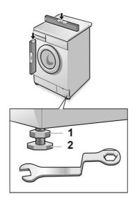
Les quatre pieds de l'appareil doivent reposer fermement sur le sol. Le lave-linge ne doit pas vaciller.
