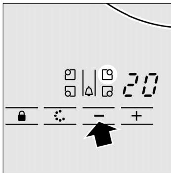
4. Effleurer le symbole + ou le symbole – jusqu'à ce que la durée souhaitée apparaisse à l'affichage de minuterie.
