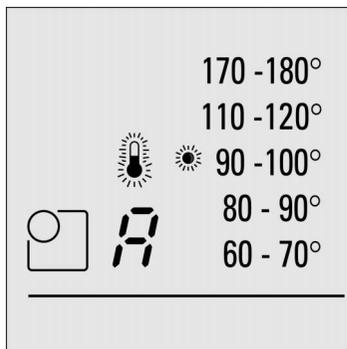
2. Ruotare l'interruttore delle zone di cottura finché la lampada spia accanto al campo di temperatura desiderato non si illumina.
