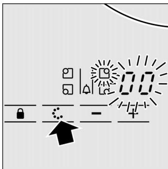
Impostare una durata per la zona di cottura desiderata. Una volta trascorso il tempo impostato, la zona di cottura si disattiva automaticamente.
