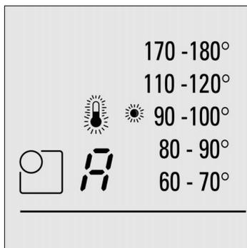
2. Tournez l'interrupteur du foyer jusqu'à ce que le voyant lumineux à côté de la plage de température souhaitée s'allume. A l'affichage apparaît un *A*. Le système sensoriel de cuisson est activé.
