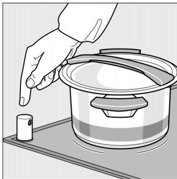
1. Appuyez sur la sonde de cuisson pour la faire sortir. Contrôlez si la fenêtre de la sonde est propre.
