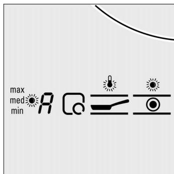
2. Ruotare l'interruttore delle zone di cottura finché la lampada spia accanto al livello di frittura desiderato non si illumina.
