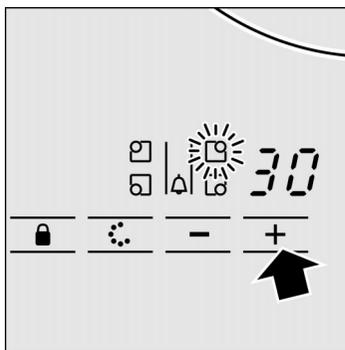
3. Het symbool + of symbool – aantippen. De voorgestelde waarde wordt weergegeven. Bij + : 30 minuten
