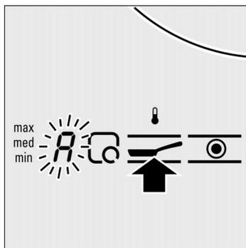
2. Tournez l'interrupteur du foyer jusqu'à ce que le voyant lumineux à côté de la position de rôtissage souhaitée s'allume.
