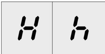
De kookplaat heeft een restwarmte-indicatie voor elke kookzone. Deze laat zien welke kookzones nog heet zijn. De restwarmte-indicatie wordt op twee manieren weergegeven.
